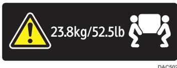
Вес принтера составляет около 23,8 кг (52,5 фунт). При перемещении принтера используйте встроенные ручки по обеим сторонам аппарата и медленно поднимайте его вдвоем.
